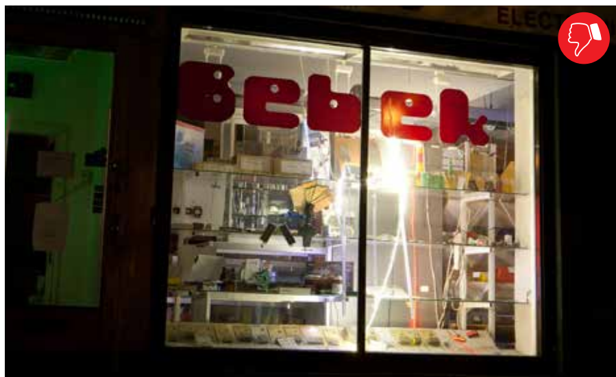
Kuva 63. Näyteikkunan liian häikäisevä valaistus. Nimikylttiä ei ole valaistu. Lasiin muodostuu häikäisevä valopiste. Sisäänkäyntiä ei ole valaistu.
